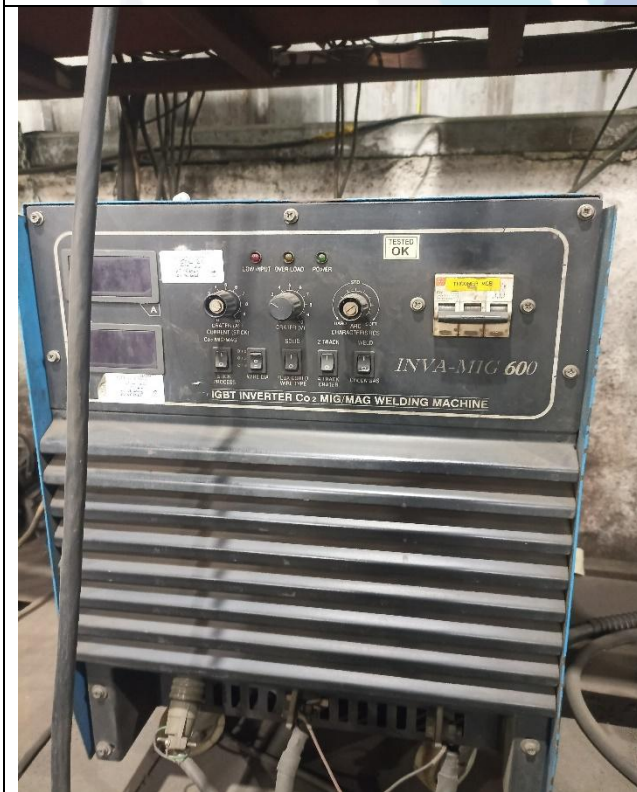
MIG CO2 Welding Machine, Model-INVAMIG-600R, Sr. No. 202008295
