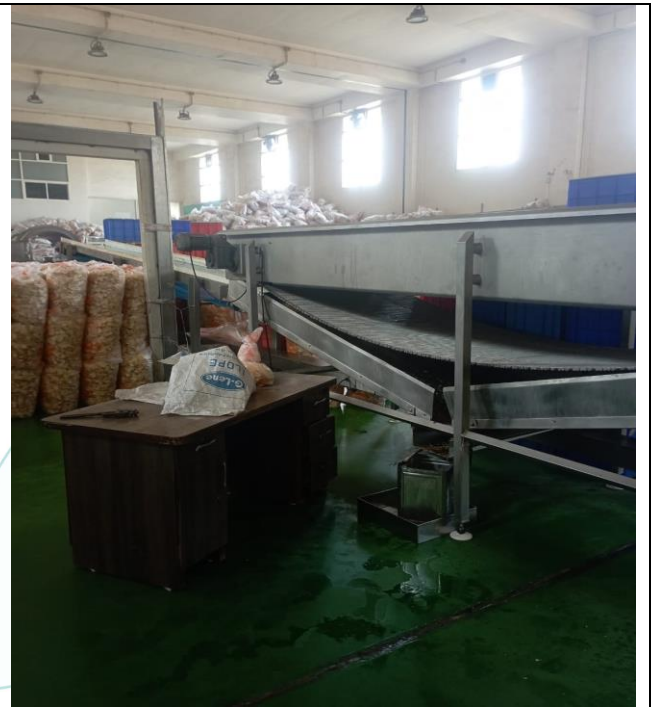
De Oiling Belt-SS304 De Oiling Incline Conveyor
