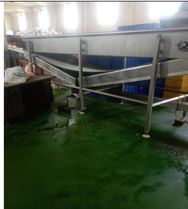
De Oiling Belt-SS304 De Oiling Incline Conveyor
